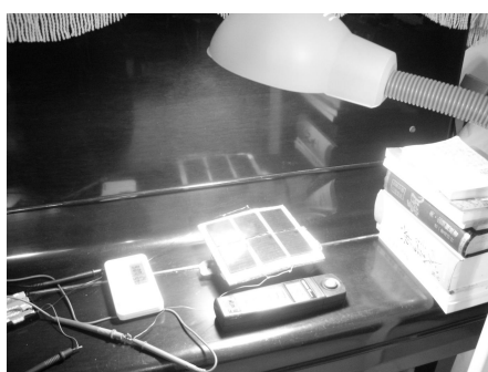
圖 12. 白色省電燈泡下(21W) 之實驗照片
