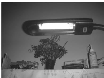
圖 10. 白色燈光的檯燈 (PL-2 燈管-13W) 實驗照片
