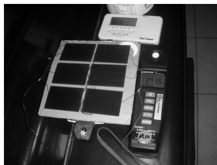
圖 7. 太陽能電池串聯與並聯之實際接線圖
